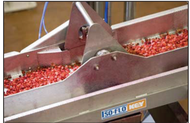
Dieser Iso-Flo Vibrationsrüttler verfügt über einen Schwenkrahmen für die Beförderung von Cranberries.
