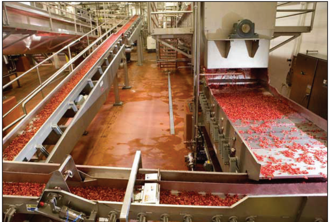
Der Iso-Flo Vibrationsrüttler ist ein integraler Bestandteil der hygienischen Ocean Spray Verarbeitungslinie.
