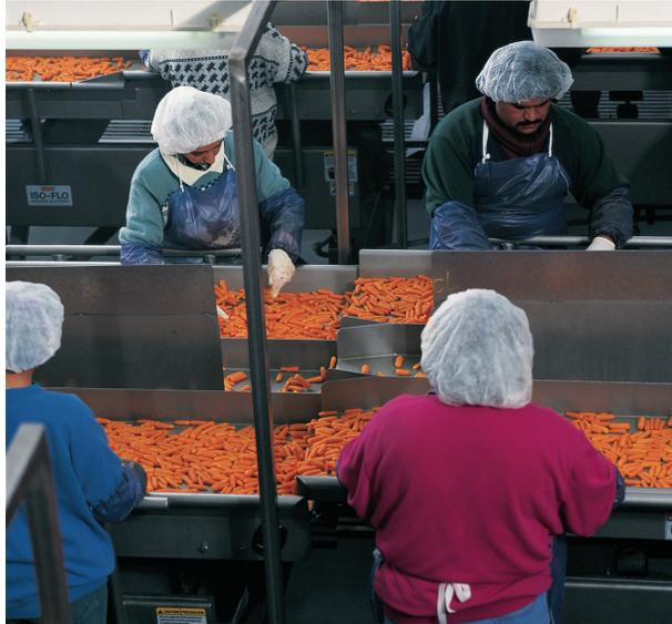
Vibrationsförderer sind ideal für Entwässerung, da die Vibration die Bindung zwischen der nassen Oberfläche und dem Produkt löst. Außerdem kann das Wasser von einem Vibrationsrüttler leicht gesammelt werden, was es dem Verarbeiter ermöglicht, es zu recyceln. Diese Entwässerungsanwendung ist ideal für ein Vielfalt von Gemüse wie grüne Bohnen, Karotten, Blattgemüse und anderes.
