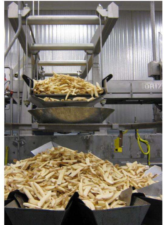
Da horizontal arbeitende Förderer schwer beladen werden können, haben sie auf der Produktionslinie etwas Kapazität für die Lagerung von Ladungen, wenn sie Produkte fördern, bei denen Beschädigung nicht wichtig ist.
