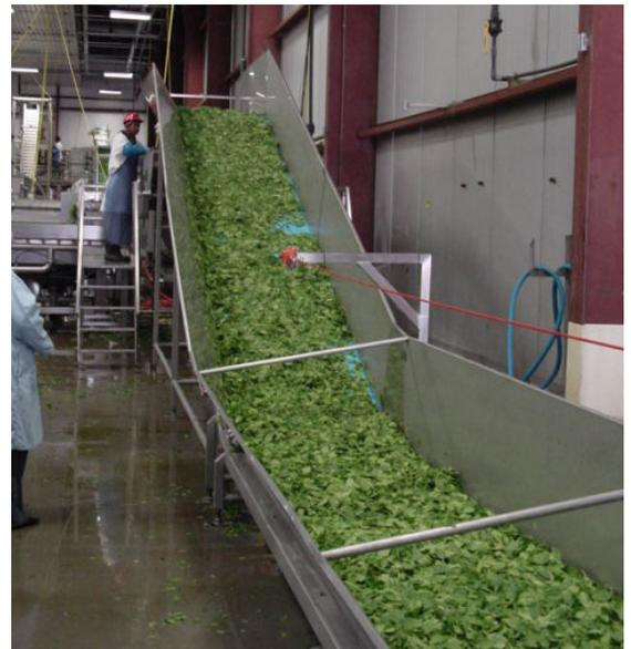
Obwohl aus der Gesamtbetriebskosten-Analyse hervorgeht, dass Vibrationsförderer und horizontal arbeitende Förderer langfristig billiger sind als Bandförderer, gibt es Anwendungen, denen am besten mit Bandförderern gedient ist und deren Nutzung trotz der höheren Kosten gerechtfertigt werden kann.
