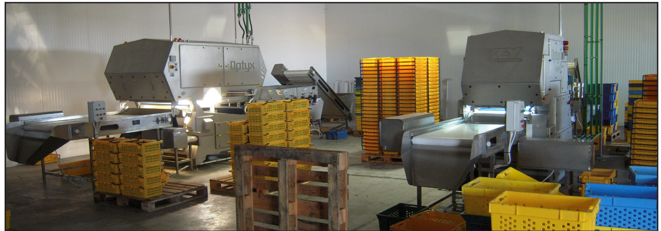
Instalación de los seleccionadores Optyx® 6000 y Optyx® 3000 en una planta procesadora de dátiles.
