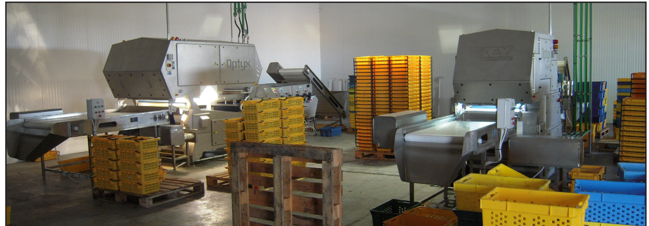
Installation de trieuses Optyx® 6000 et Optyx® 3000 dans une usine de traitement des dattes
